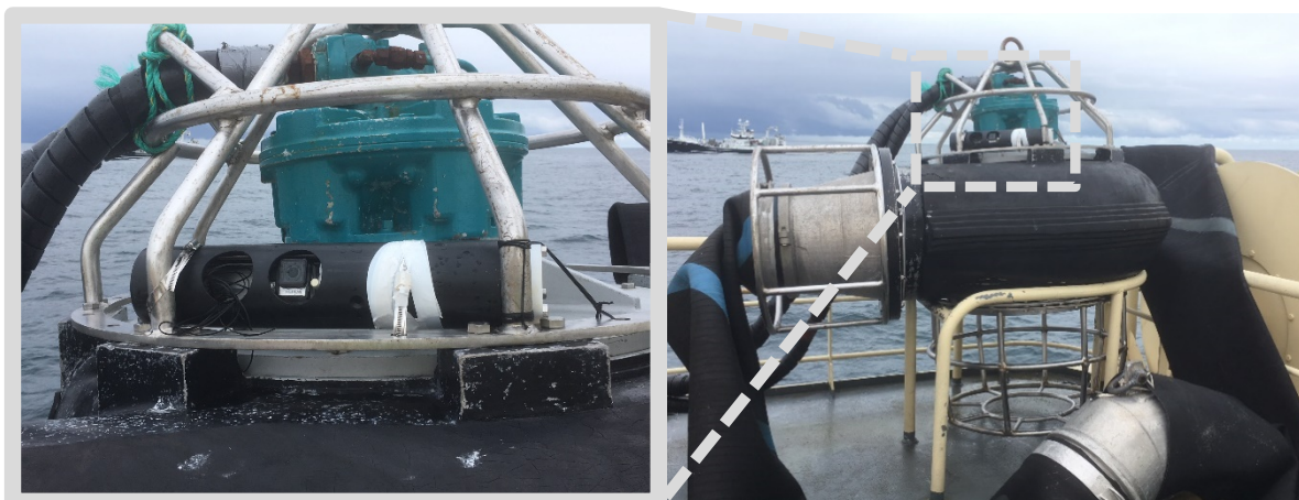
Figur 3. Fangstovervåkningssonden (CMP-pump) montert på fiskepumpen
